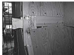
写真5 柱の曲げ破壊
