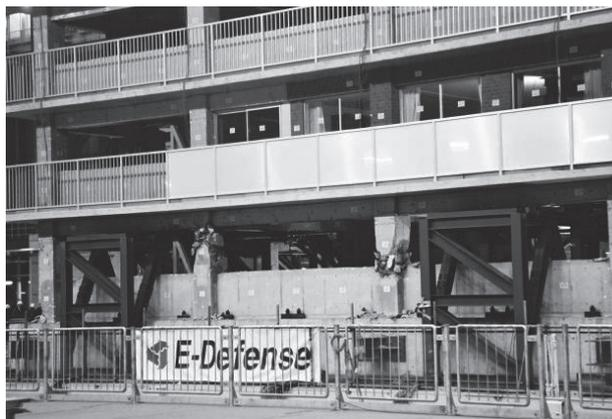
写真4 実大RC6階建て建物の震動破壊実験
