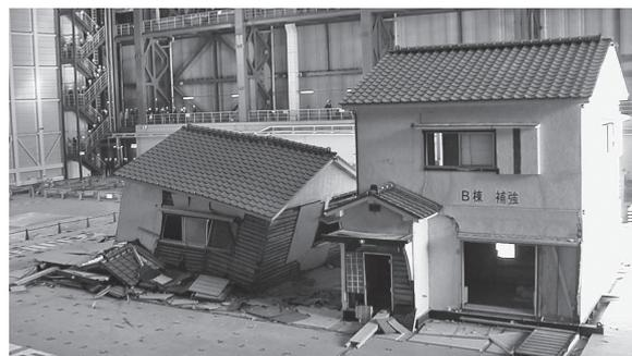
写真2 移築補強・無補強試験体
