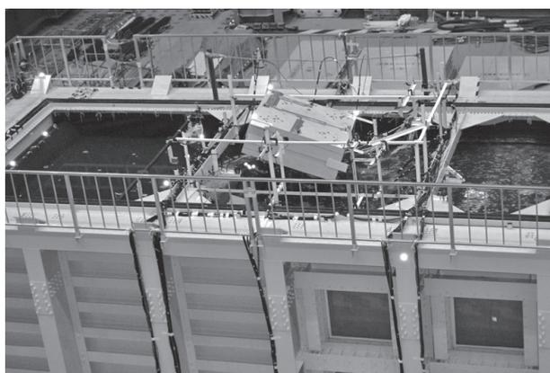
写真2 側方流動に伴う護岸とその背後杭基礎の実験
