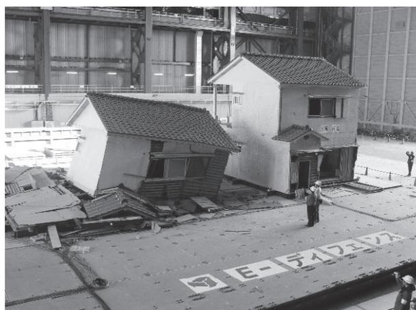
写真3 木造家屋の震動破壊実験
