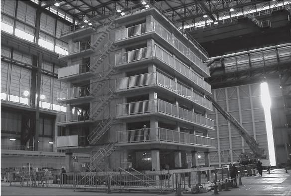
写真4 震動台上の試験体(北東面)
