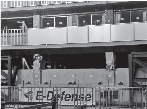
写真5 実験後のRC試験体
