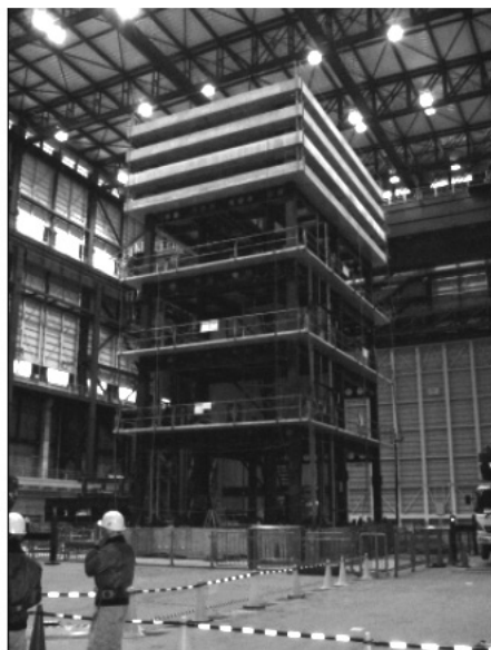
図7 Eディフェンスにおける高層建物の実験
