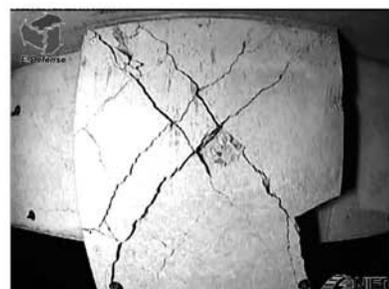
(c) 純フレーム構造で問題となる柱梁接合部の破壊モード
