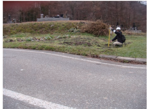
写真4 国道406号と地表地震断層が交差する地点。畑で約30cm、路面で約45cmの変位が認められる。畑では幅1m程度の撓曲を伴い、隆起側には開口割れ目もみられる。墓の高まりは変動地形で、地表地震断層が既知の活断層位置にほぼ一致することが明らかである(地点③)
