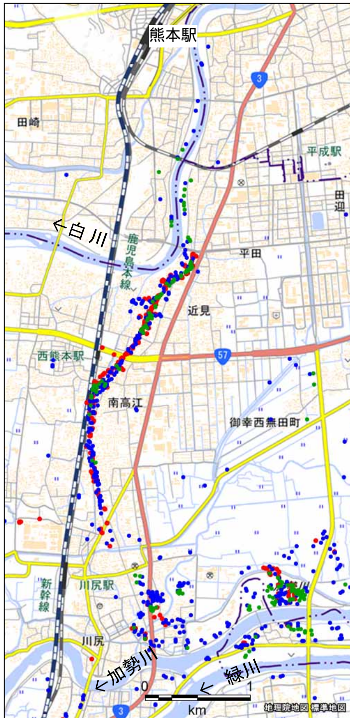
図10 熊本市南区近見～川尻の液状化発生地点は旧河道か？
