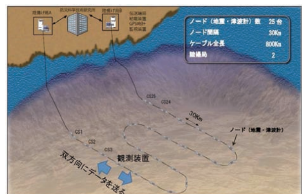
図3 S-netサブシステムの概要
