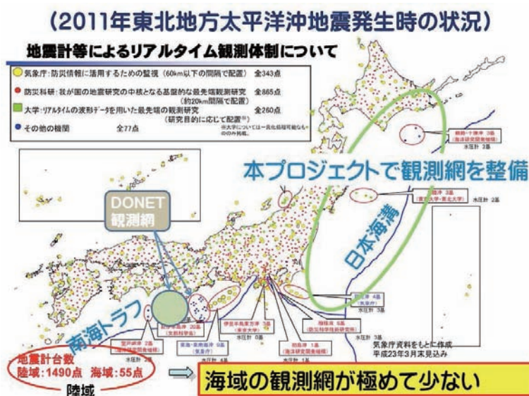
図1 2011年東北地方太平洋沖地震発生時の地震計等によるリアルタイム観測体制の状況
