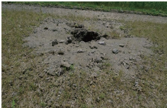
写真8 最大径15cmの礫の噴出(御船町陣)
