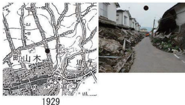
図7 火砕流台地における「崖道」の崩壊
