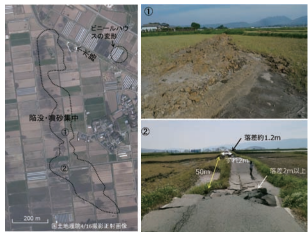
写真9 阿蘇市役犬原における噴砂と変状(図5の①) 3)
