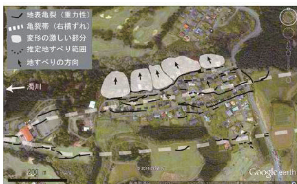
図3 カントリータウンにおける地表亀裂と地すべり
