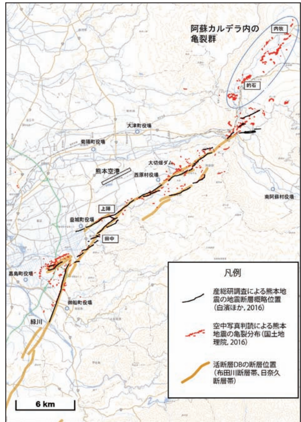
図4 2016年熊本地震の地震断層分布(黒線)と空中写真判読による亀裂分布(赤線)および活断層DBの活断層線の比較(地理院地図を使用)
