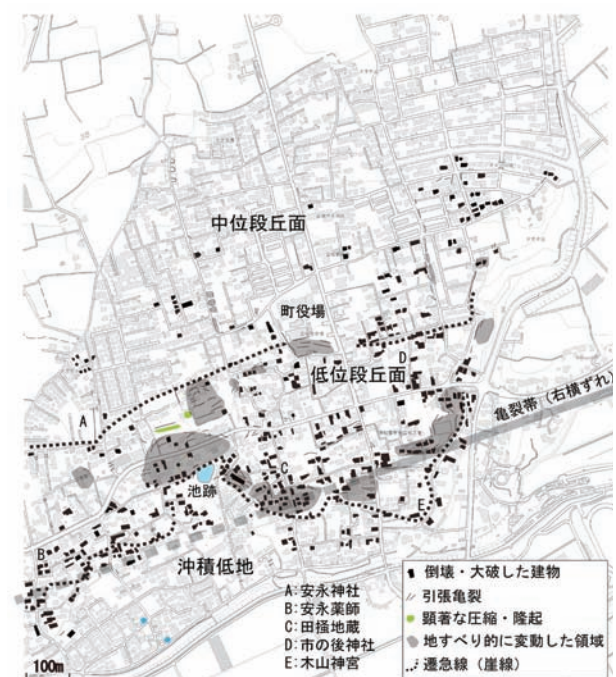
図6 益城町中心部の被害分布と地表変動
