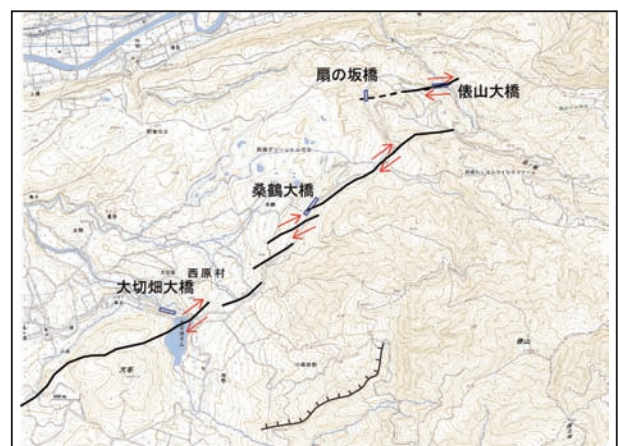
図6 県道28号線沿いの橋梁と地震断層
