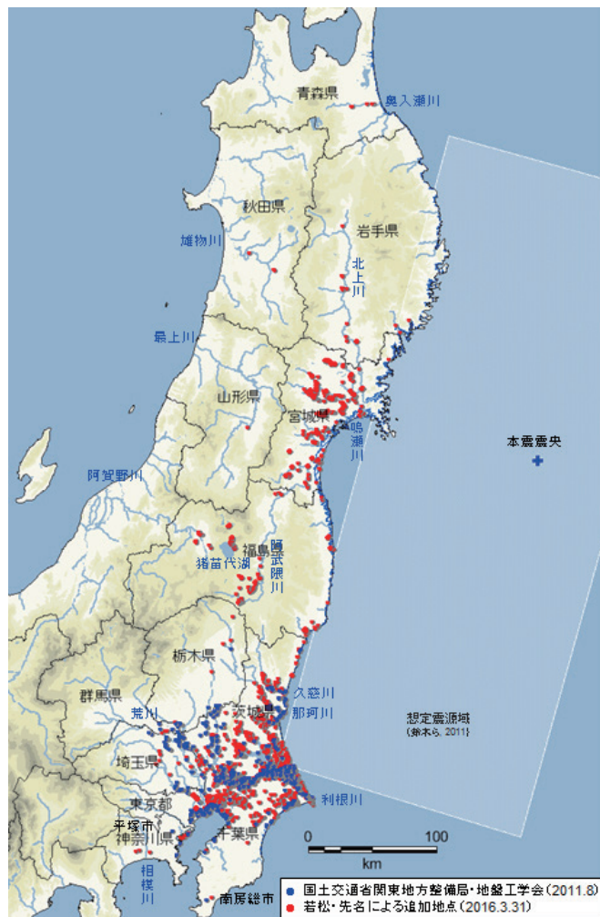
東北地方太平洋沖地震により液状化が確認された地点の分布 (13都県193市区町村)
