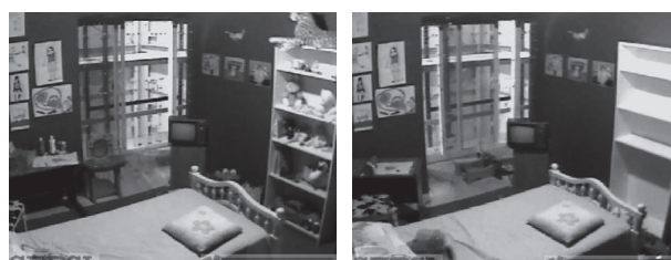
図7 加振前後の損傷状況
