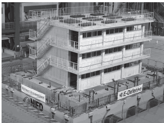
写真1 既存RC試験体
