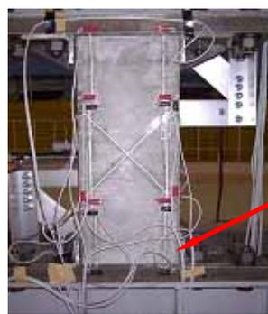
(d) Aluminum tape for RFID tag sensor
