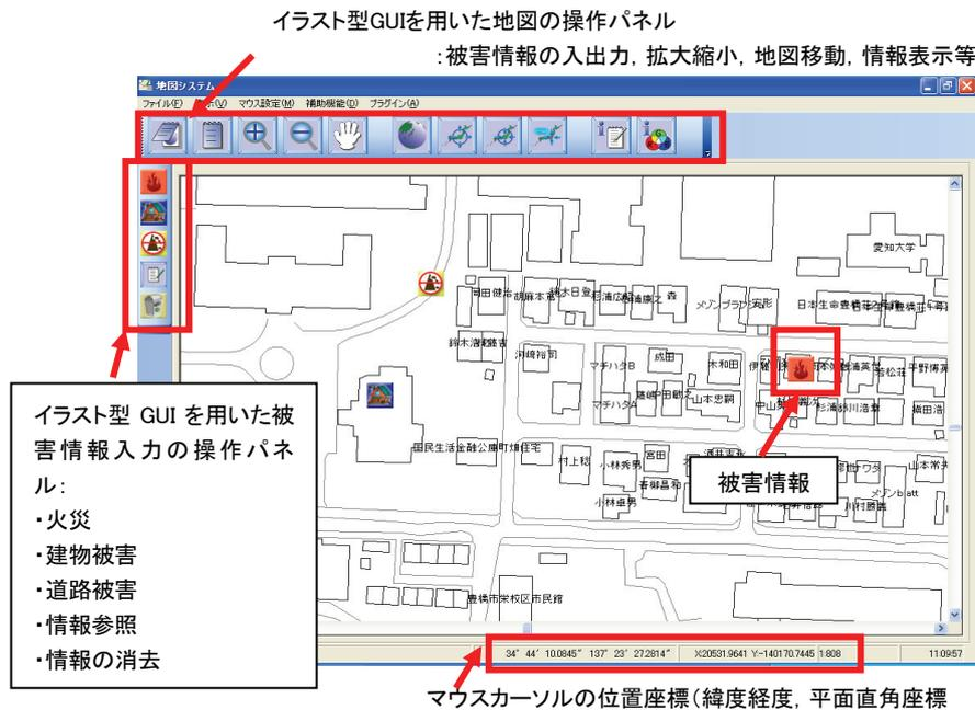
図2 被害情報収集支援システムの画面構成
