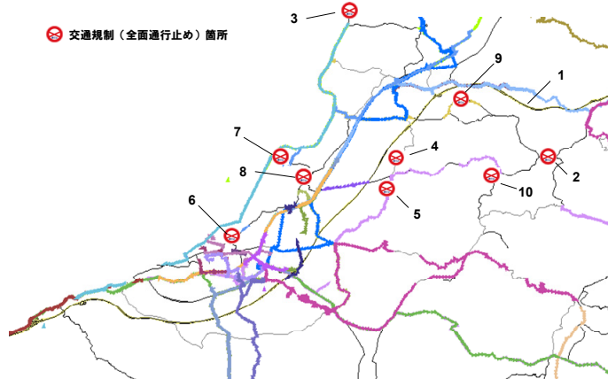
図5 柏崎市周辺のプローブカーの軌跡（2007年7月16日）と交通規制箇所 20) （2007年7月17日9時現在） （交通規制箇所の番号は、表1のIDと対応）
