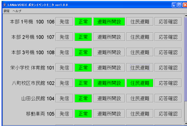
図7 IP電話を用いた避難所開設状況提示システム
