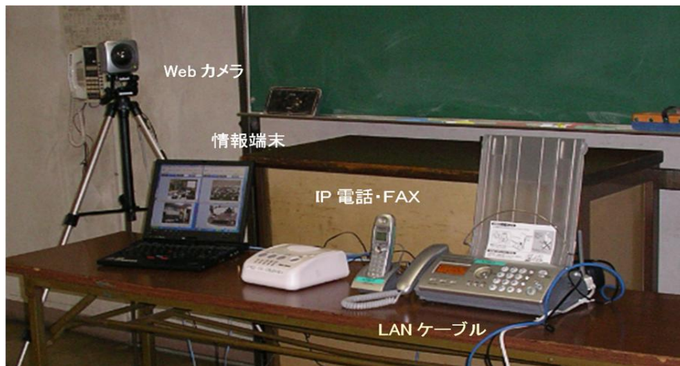
図2 情報端末、Webカメラ、IP電話&FAXからなる拠点用防災情報システム
