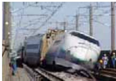
とき 325号最後尾車両(約30°傾斜) 下り線 207k580m付近
