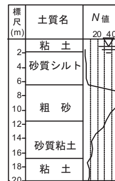
図4 刈谷田川旧河道の土質柱状図 2) (図2のC地点)
