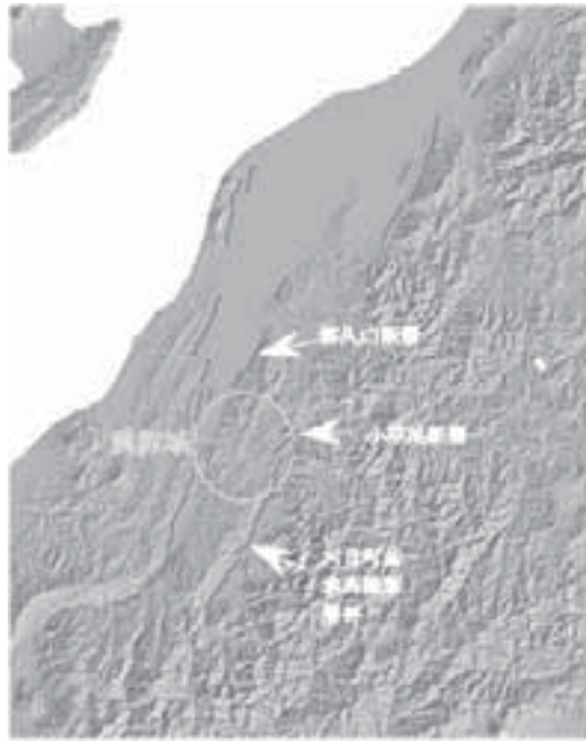
図6．震源域周辺の活断層（池田安隆・他編、2002、堤浩之・他：国土地理院（都市圏活断層図）2001による）。六日町盆地西縁断層帯、小平尾断層が、魚沼丘陵の当園に分布している。これらは、西側が隆起する逆断層。魚沼丘陵の北西縁には、東側隆起の悠久山断層が分布。震源域中南部では西傾斜の断層、北部では東傾斜の断層が推定されている。断層の名称は、都市圏活断層による。
