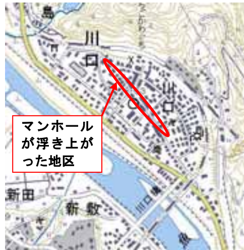
図5 川口町でマンホールの浮上りが顕著だった区域(基図は国土地理院の1/25,000地形図による)
