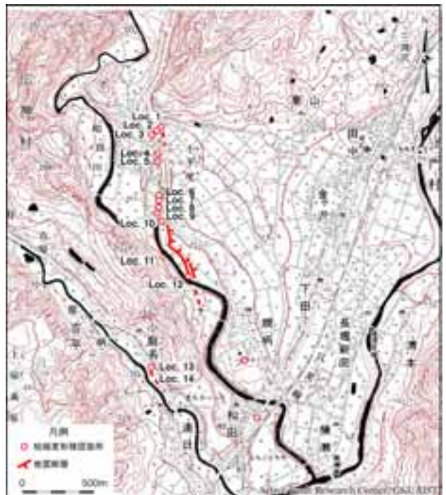
図4 六日町断層の北方に出現した地表断層。
