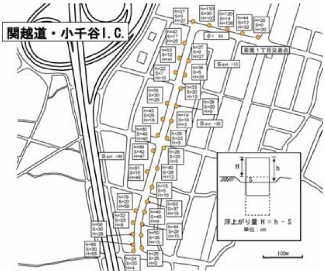
図3 小千谷市若葉2丁目におけるマンホールの浮上り量および近傍地盤の沈下量の大きな測定結果
