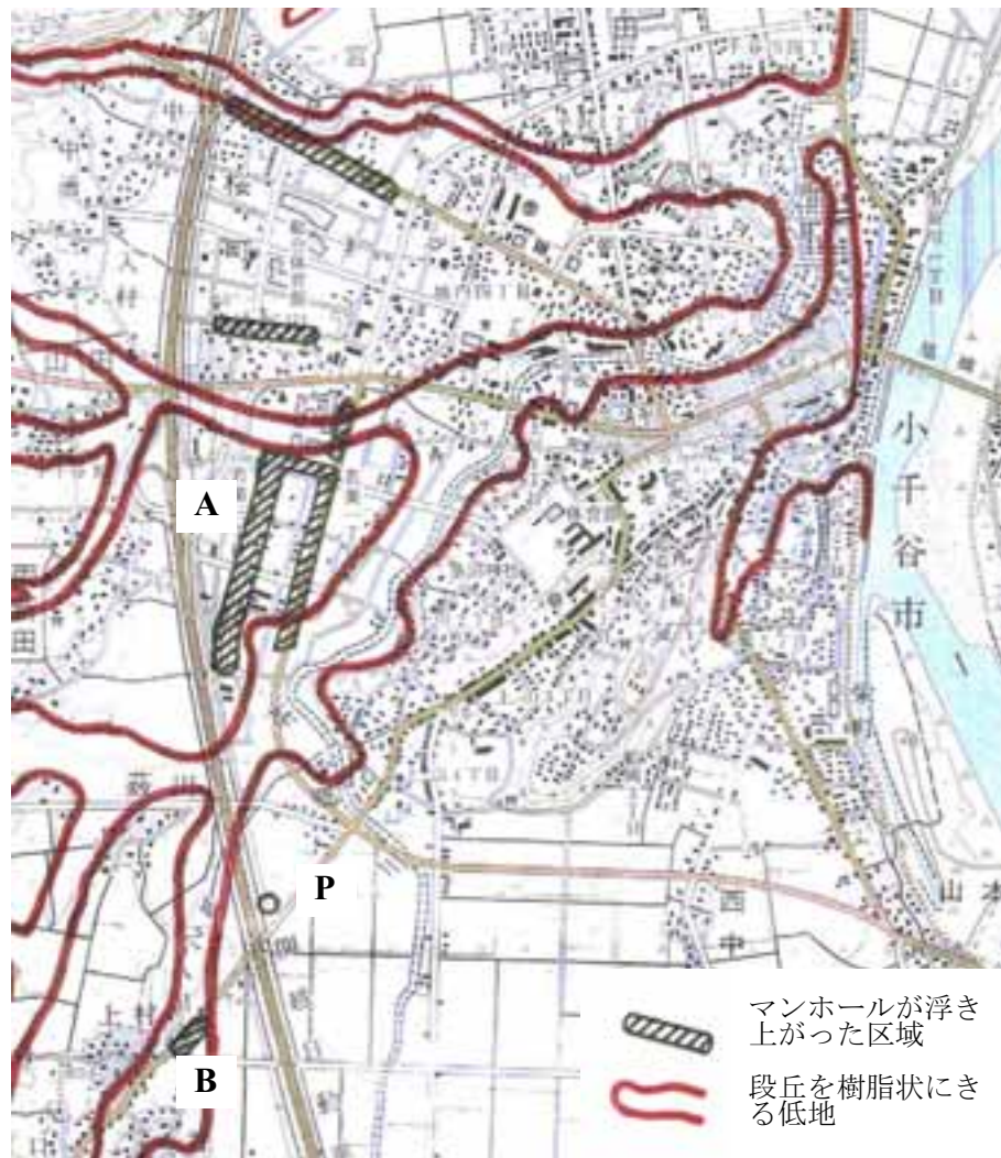
図2 小千谷市若葉付近でマンホールの浮上りが見られた区域と段丘に樹脂状にはいつている低地(文献2をもとに描いたもの)、およびボーリング位置(基図は国土地理院の1/25,000地形図による)
