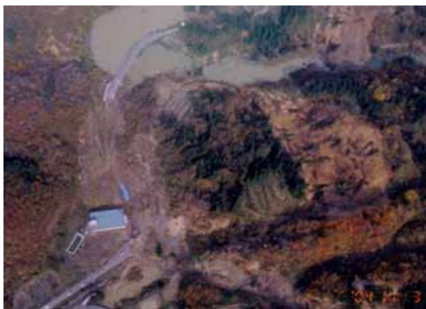
写真2 山古志村東竹沢地区の地すべり。地すべり土塊は写真右側から左の方向へ移動し、芋川を堰き止めた（11月3日撮影）
