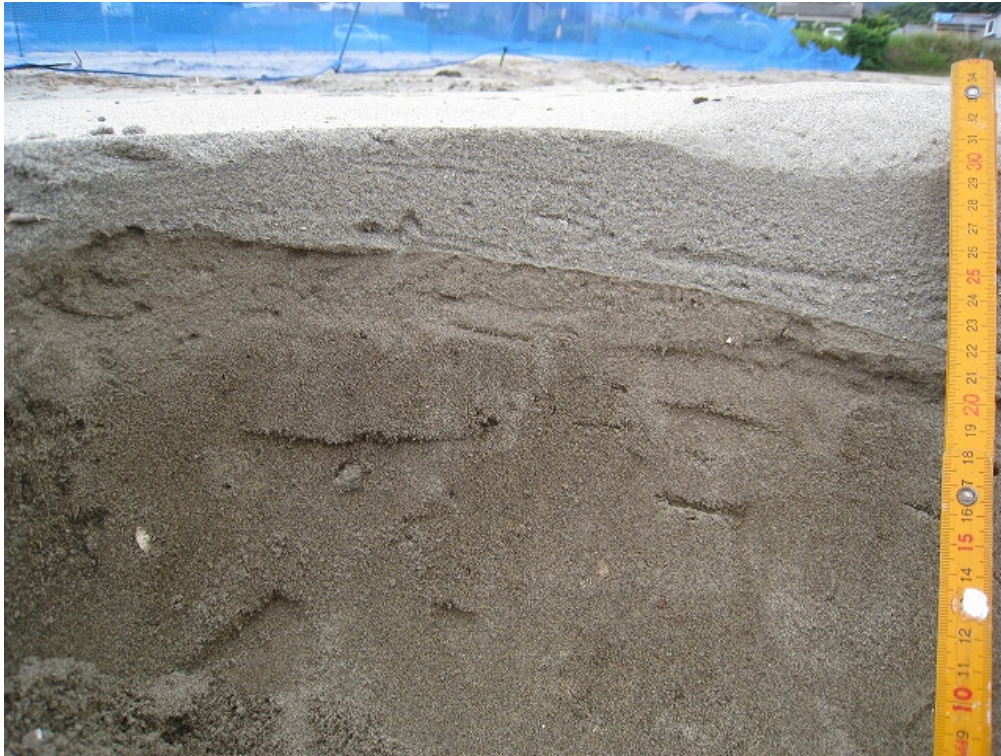
写真8 噴砂孔No.29の断面、上位の白色細粒砂が噴砂、下位の礫混じり黄褐色中粒砂が畑の耕作土
