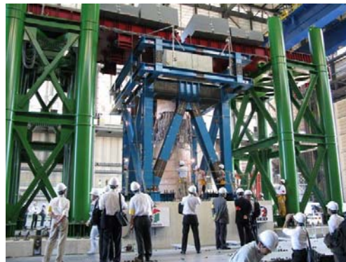
写真2 試験後の供試体（橋脚上部に曲げせん断破壊）
