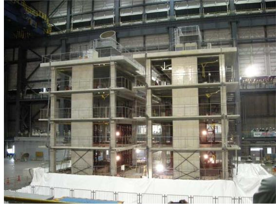
写真 2 振動台実験状況（実験後）
