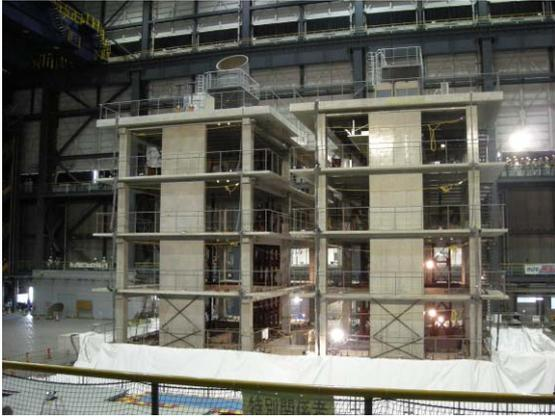
写真 1 振動台実験状況（実験前）
