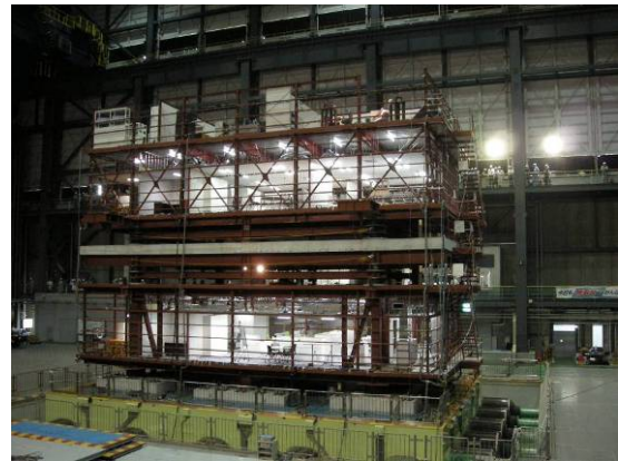
写真 2 振動台実験状況（実験後）
