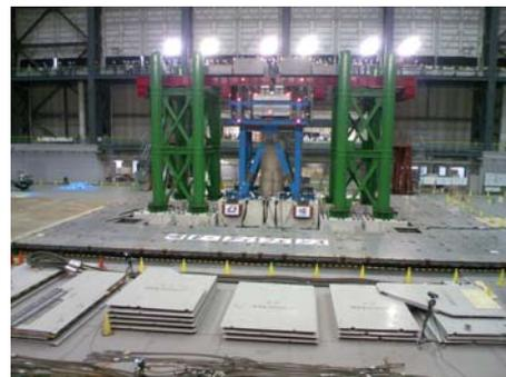
写真 2 試験後の試験体（柱基部に曲げ破壊）
