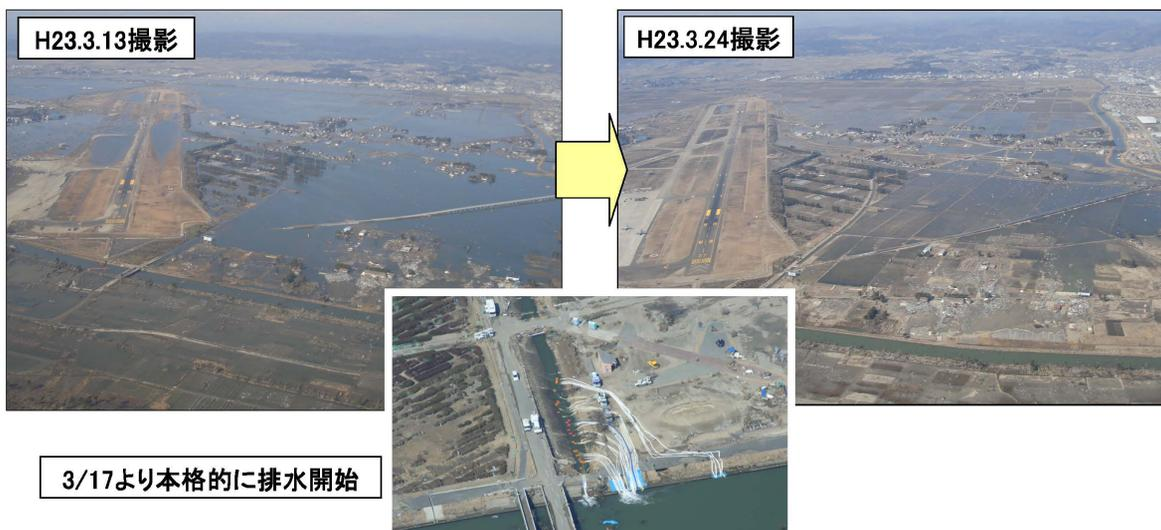
写真6 浸水した仙台空港の排水状況
