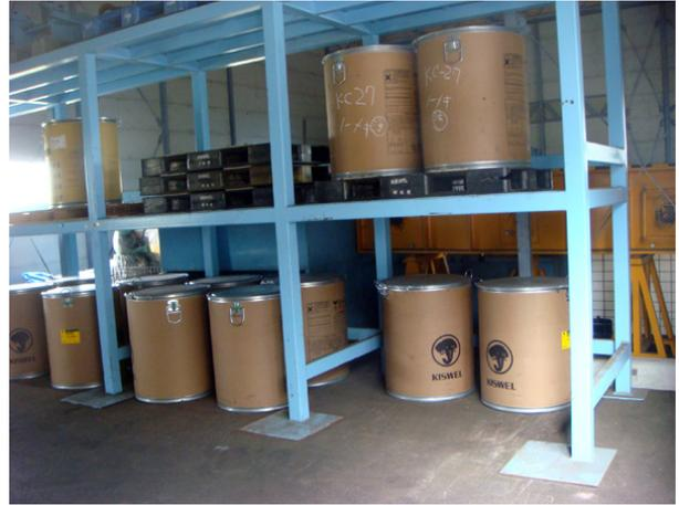
図9 脚部設置板の改善による被害の低減・防止
