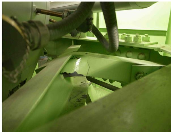
図1 ボイラ振れ止め部の損傷
