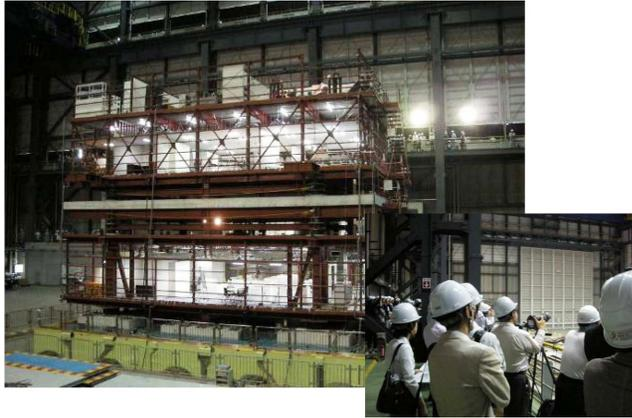
写真1 振動台実験状況(イベント①)
