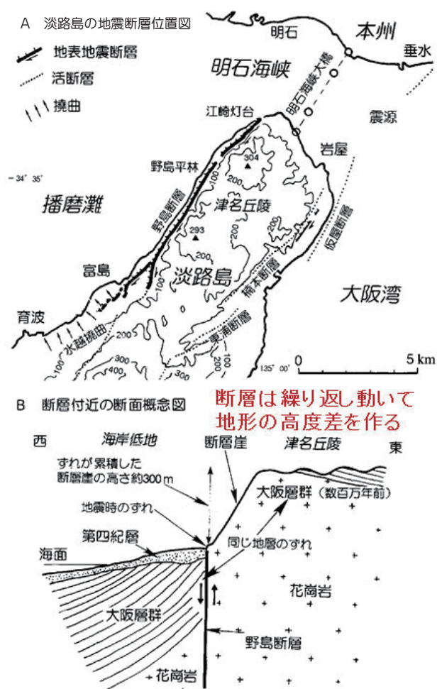
図1 A:淡路島の地震断層＝活断層野島断層の位置 B:野島断層を横切る東西断面。地震断層は急崖の麓の断層破碎帯に沿って現れ、断層の両側で大阪層群の分布高度も大きく食い違っている 5) 。
