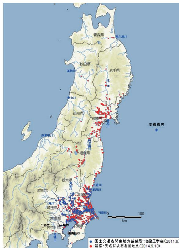
図1 東北地方太平洋沖地震により13都県193市区町村で液状化が確認された地点<sup>6)</sup>
