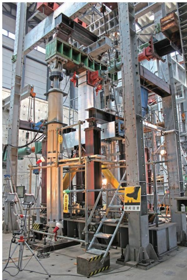
写真1 ダンパーを組み込んだRC部分架構実験
