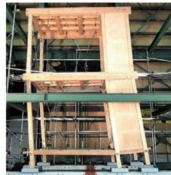
写真1 木造軸組架構の振動台実験の様子
