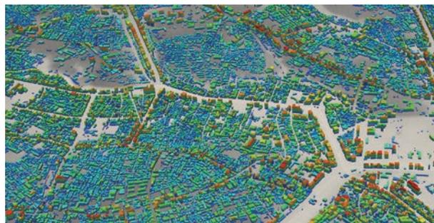
図1 大規模三次元有限要素解析による地盤震動解析と、その結果を用いて実施した建造物の応答解析例
