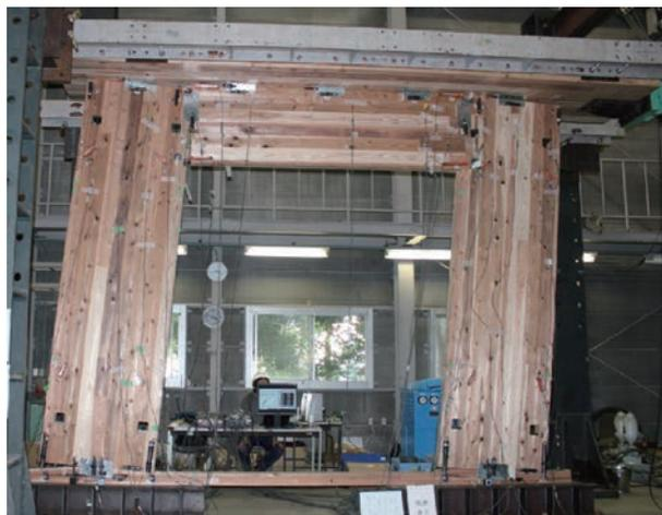
写真2 CLTパネル工法による垂れ壁付きフレームの実験 (@建築研究所)
