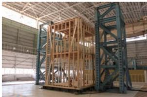
写真1 実大木造建物の振動実験
