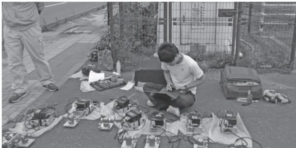
北海道胆振東部地震後にK-NET 鶴川の前で微動観測機材のチェック
