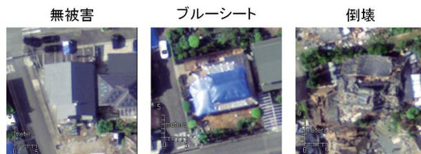
図4 各被害レベルのパッチ画像の例<sup>6)</sup>
