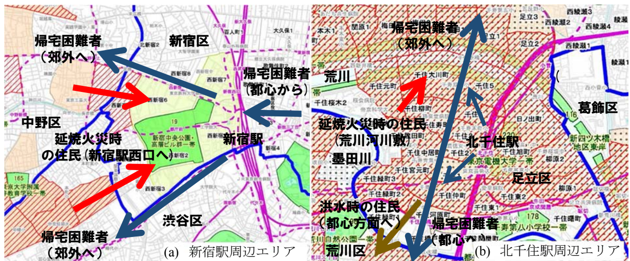
図3.2.4 新宿駅・北千住駅エリアと震災時に想定される帰宅困難者や周辺住民の群集移動の向き (文献 13) に加筆；緑は火災時避難場所、黄色は地区内残留地区、橙色は総合危険度の高い地域、 赤い網掛けは火災危険度が高い地域、ドットは建物倒壊危険度が高い地域)
