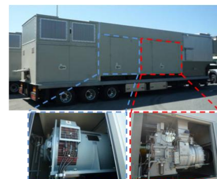
発電機 3, 200kW×6台設置 ガスタービン
