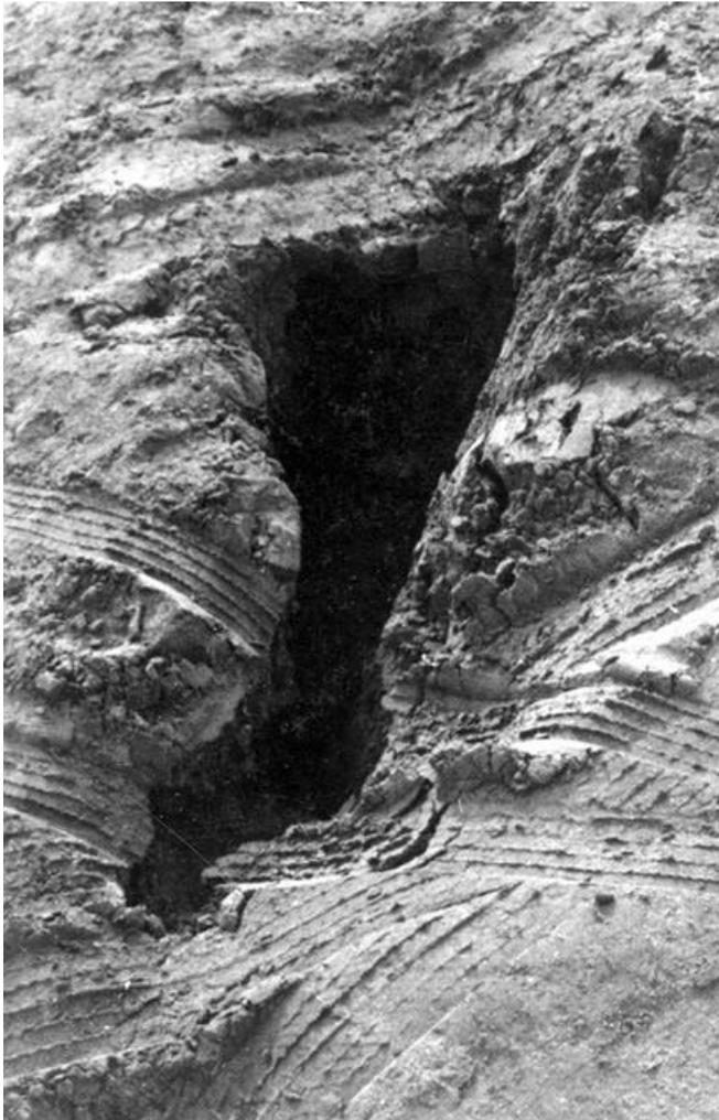
細長い噴砂孔。周囲には砂が厚く堆積している。
