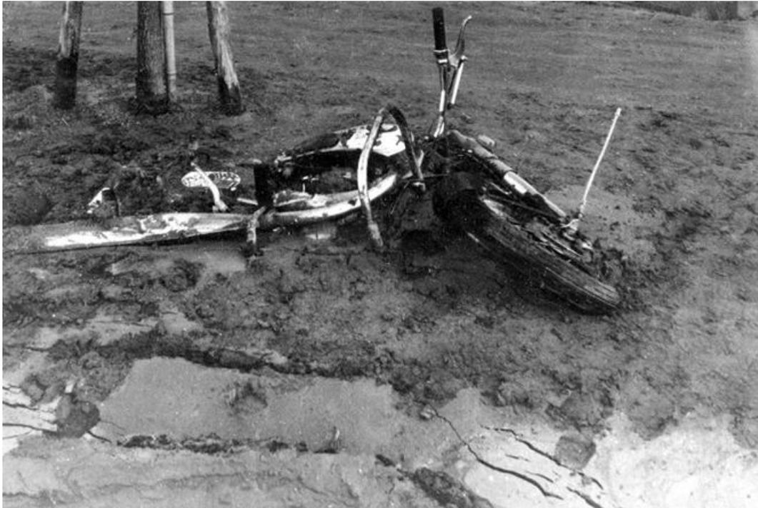
液状化で地面はまだ濡れている。バイクが噴砂の中に埋まっている。
