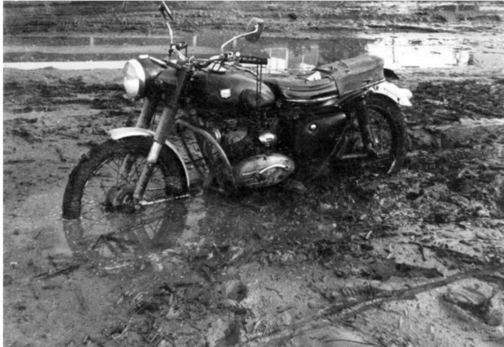
バイクが液状化で噴出した土砂の中に埋まっている。津波の影響か、バイクの背後はまだ冠水している。
