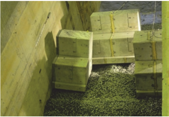
図-2.8 釜石港モデルのケーソンの倒壊の様子
