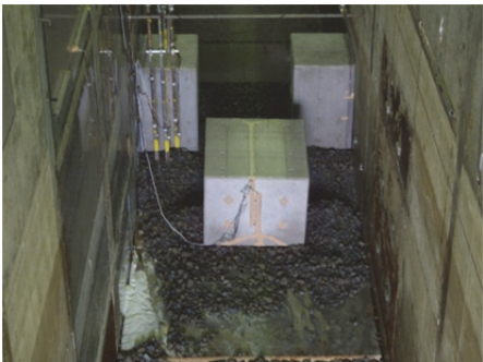
図-2.9 御前崎港モデルのケーソンの倒壊の様子
