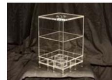
低抗力型建築物の水理模型実験モデルの例
