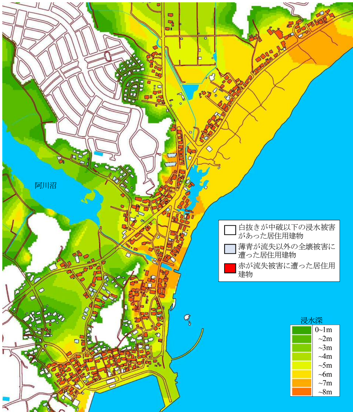
図 2.3.5 菖蒲田浜地区の被災建物と浸水深
