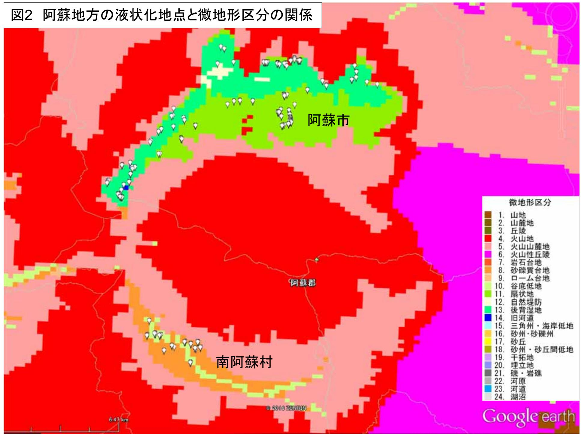
図3 2016年熊本地震で液状化(噴砂)を確認した地点の分布(第1報に阿蘇地域を加筆)
