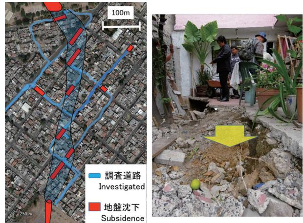
図5 住宅地で生じた地盤沈下の分布と被害の様子
