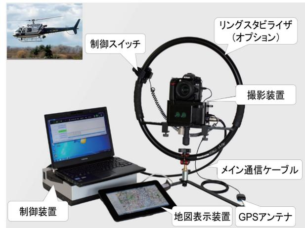
図1 携帯型斜め写真撮影システム (PALS)
