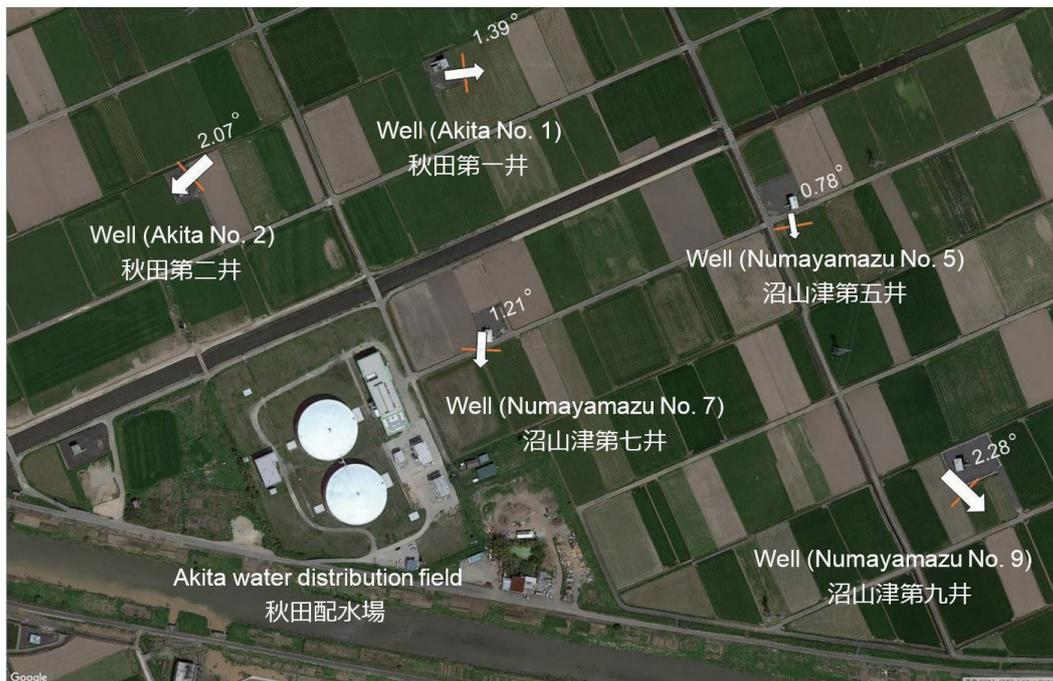
図7 秋田配水場付近の井戸ポンプ建屋の傾斜角と方向<sup>4)</sup>
