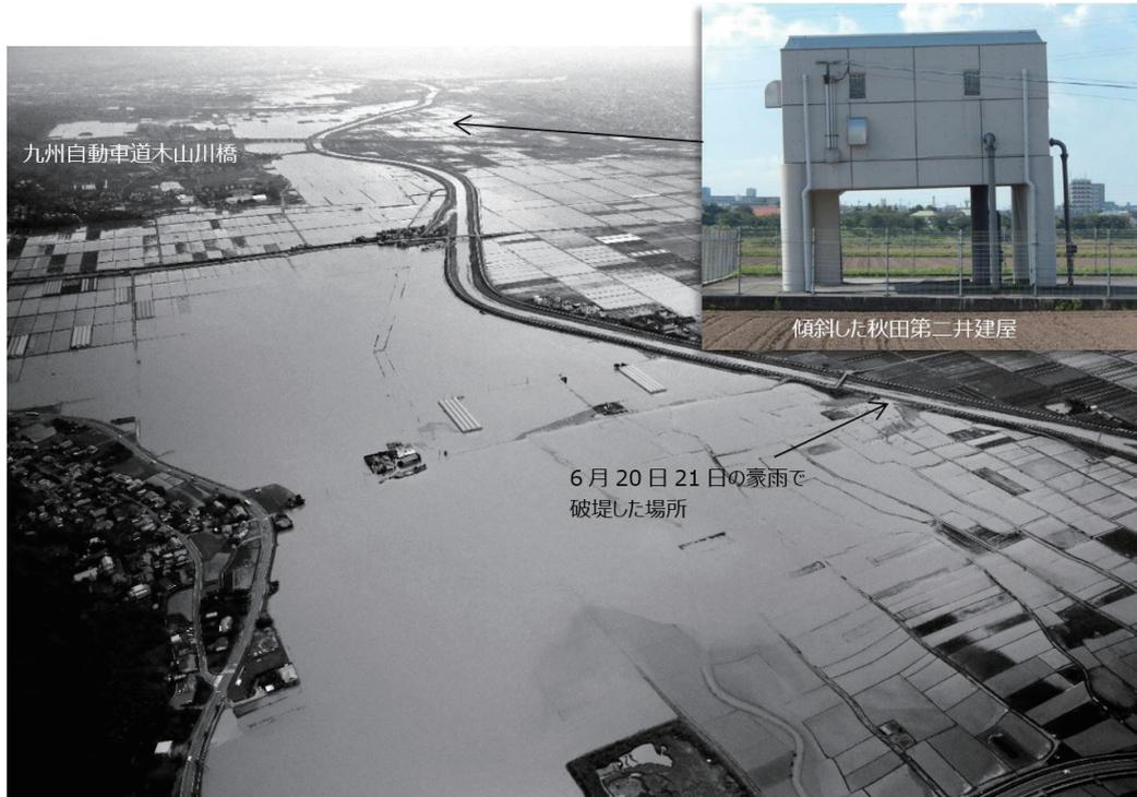
図6 傾斜した秋田第二井建屋と、6月20日、21日の豪雨による木山川破堤と浸水状況
