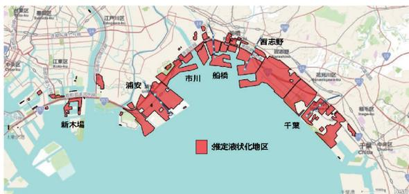
図6 東北地方太平洋沖地震により東京湾の埋立地で液状化した地区(国土交通省関東地方整備局と地盤工学会による)
