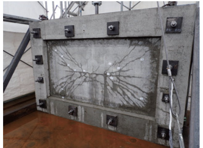
写真4 壁の水圧破壊実験
