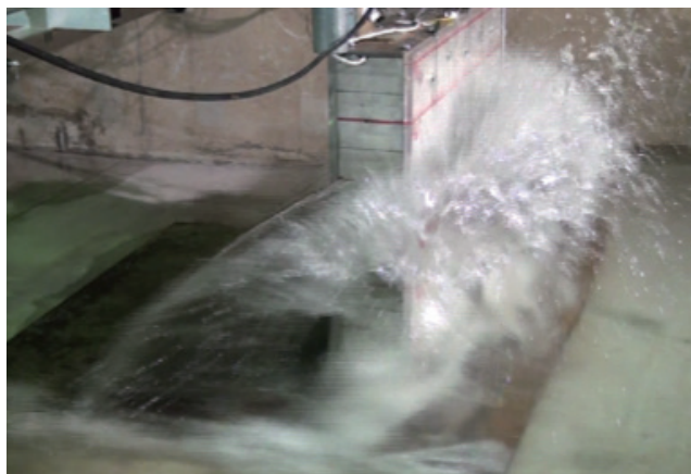
写真3 津波荷重による転倒破壊実験
