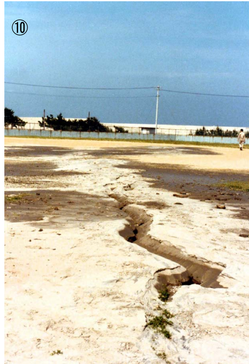
野球場の地割れと噴砂 (1978年6月14日陶野郁雄氏撮影、位置は図1)
