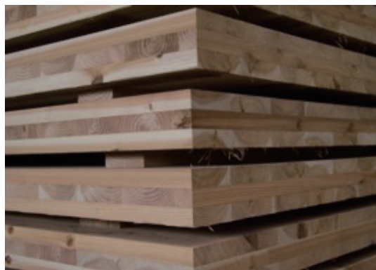
写真 1 CLT（左：丸太と挽き板、右：製造された CLT パネルの断面）
