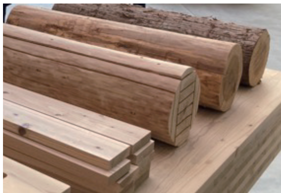
写真 1 CLT（左：丸太と挽き板、右：製造された CLT パネルの断面）
