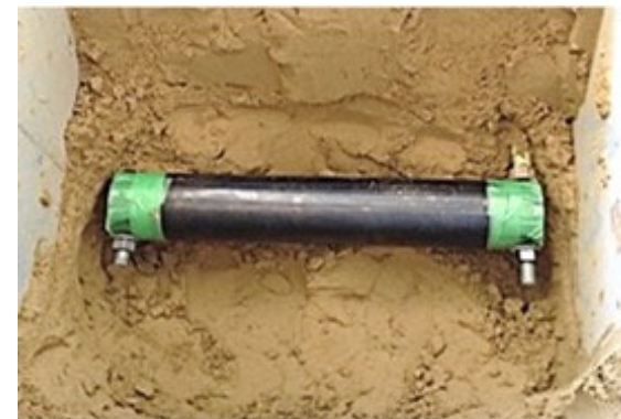
供試管設置の様子
