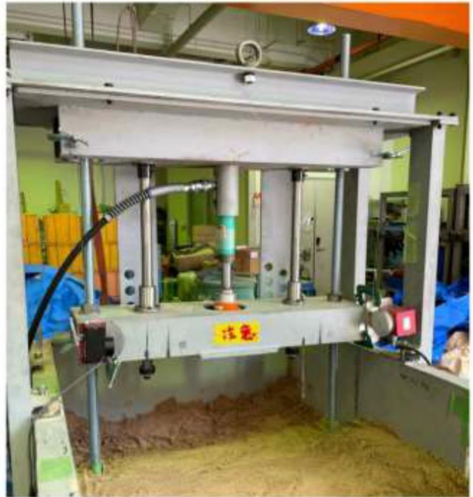
(b) 鉛直押し込み载荷時のフレームと土槽
