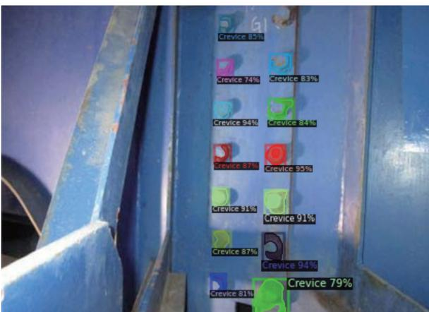
図3 Mask R-CNNによる腐食認識
