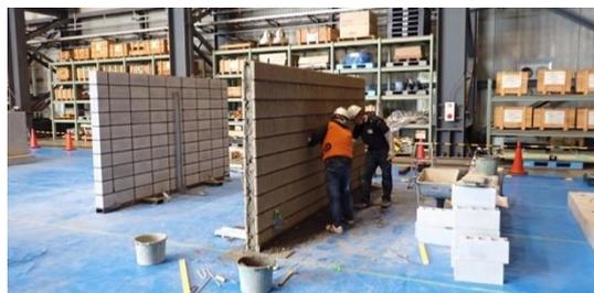
図1 ブロック塀試験体の製作状況
