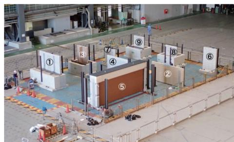
写真2 震動台上の試験体（加振前）
