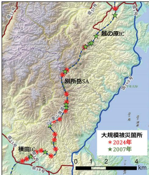
図5 のと里山海道横田IC～能登大橋間の大規模被災箇所の比較<sup>1),5)</sup>
