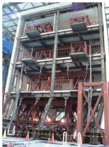
写真2 E-ディフェンス：4層鉄骨造建物に対する崩壊実験：柱や梁が大きな損傷を受けた後、最後は1層が崩れ落ちた。（2007年9月27日、筆者撮影）
