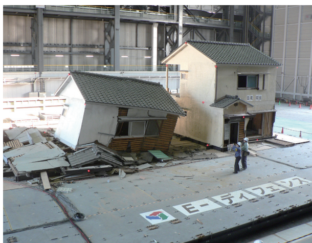
写真2 木造住宅の補強効果の検証実験(2005年)
