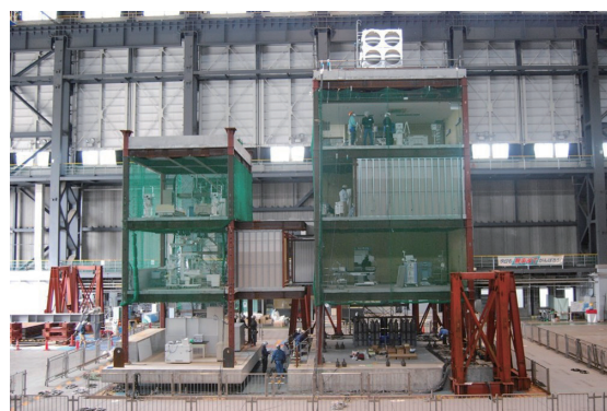
写真8 免震病棟と耐震病棟の同時加振実験(2019年)
