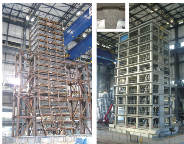
写真5 高層建物の破壊実験 (左：18層鉄骨造2013年／右：10層RC造2015年)
