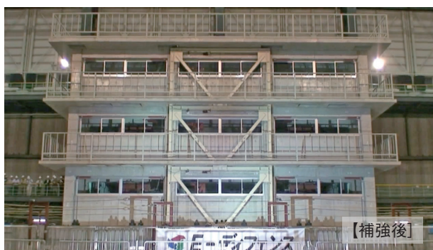
写真3 RC造校舎の補強効果の検証実験(2006年)
