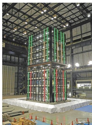
写真9 10層鉄骨造試験体(2023年)
