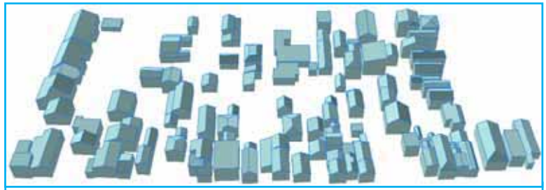
ブレイクラインより作成した3次元建物モデル
