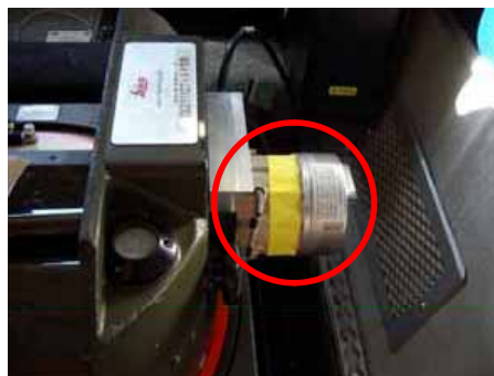
航空カメラに 取り付けられたIMU
