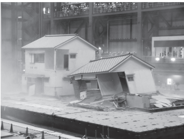
写真9 移築試験体の倒壊挙動(手前A棟、奥B棟) (写真提供: 独立行政法人建築研究所、河合直人氏)
