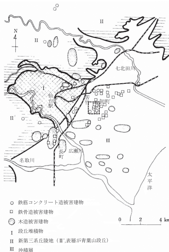
図5 建築被害と地盤
