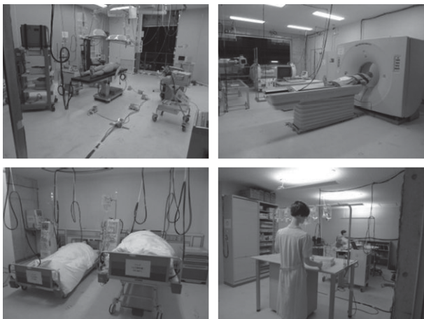
図9 免震病院試験体内に設置された医療設備群
