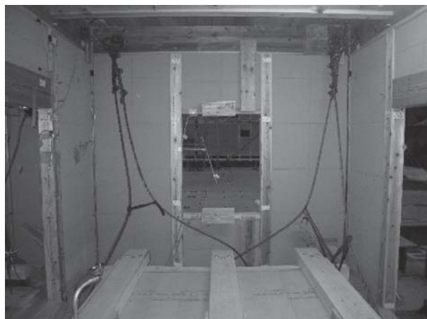
写真6 試験体室内に設置した倒壊防止ワイヤー
