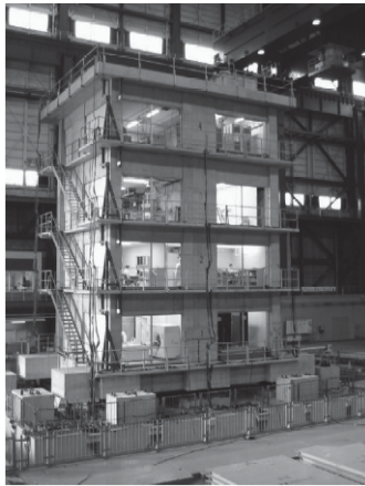
図8 4階建てRC造免震病院試験体
