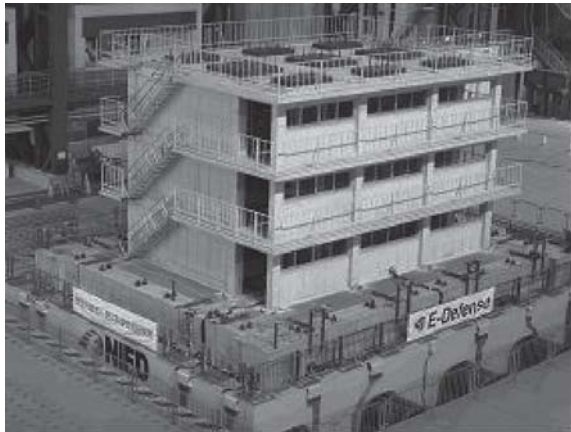
写真1 既存RC試験体
