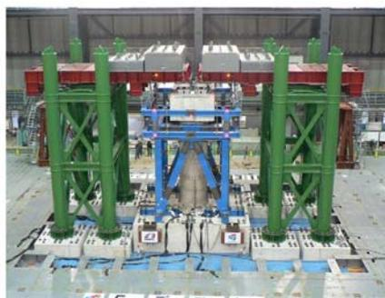
写真5 RC橋脚実験
