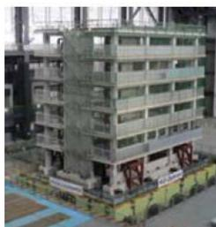
写真2 鉄筋コンクリート建物実験
