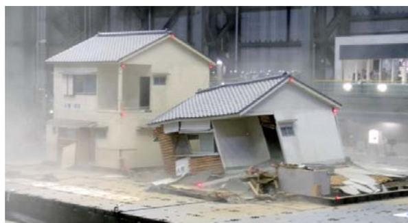
図3 補強無補強建物実験
