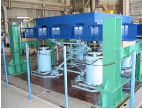
図3 3次元免震構造実験
