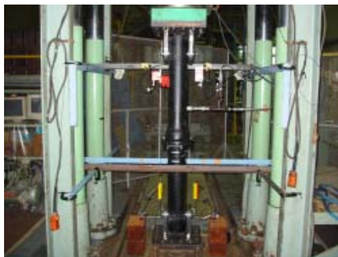
写真1 継手引張り強度確認試験
